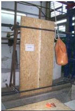
c) *Ensayo de choque duro*
