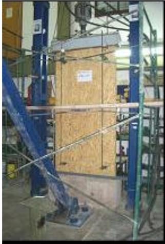
a) *Ensayo de compresión axial*
